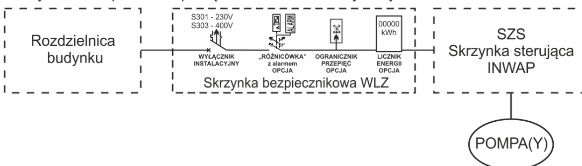
Wersja 2 - WLZ pośrednio podłączona do rozdzielnicy budynku
